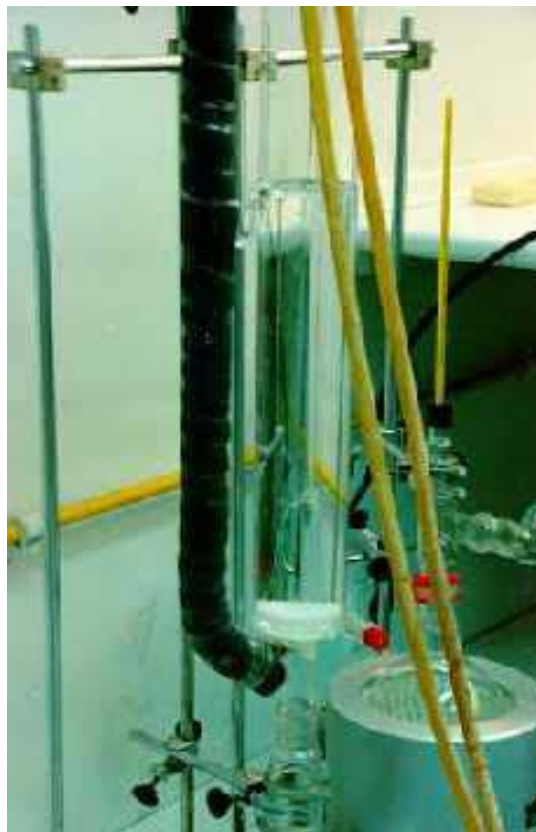
Detalle de la extracción del formaldehído durante el ensayo del perforador EN 120
