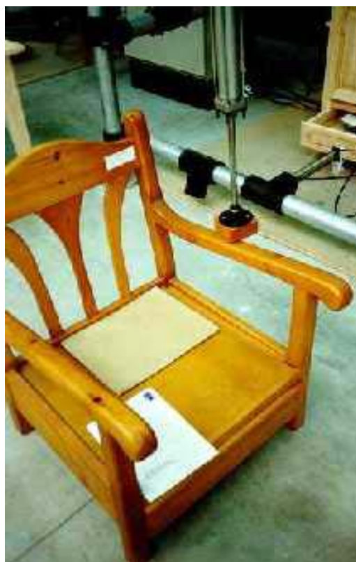
Carga estatica vertical sobre reposabrazos. UNE 11.012.89 Apdo 2.5.4
