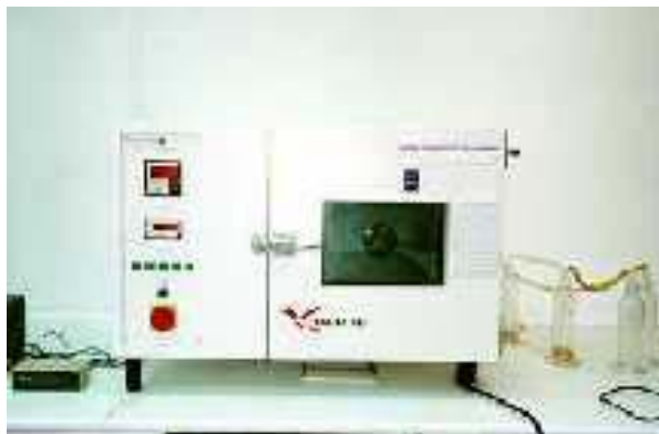
Emisión de formaldehído por el método de análisis de gas. UNE-EN 717/2 Parte 2
