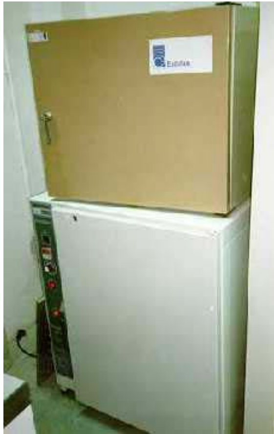
Estufas, para la realización de los ensayos de humedad y ciclos de envejecimiento.
