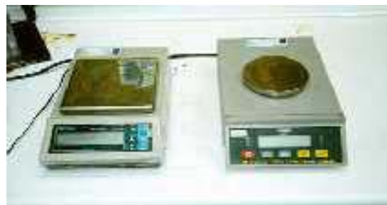
Balanzas para pesada de probetas durante la realización de los ensayos de humedad, densidad, hinchazón y absorción de agua. UNE 56.774.92, UNE 56.775.92, UNE 56.776.92
