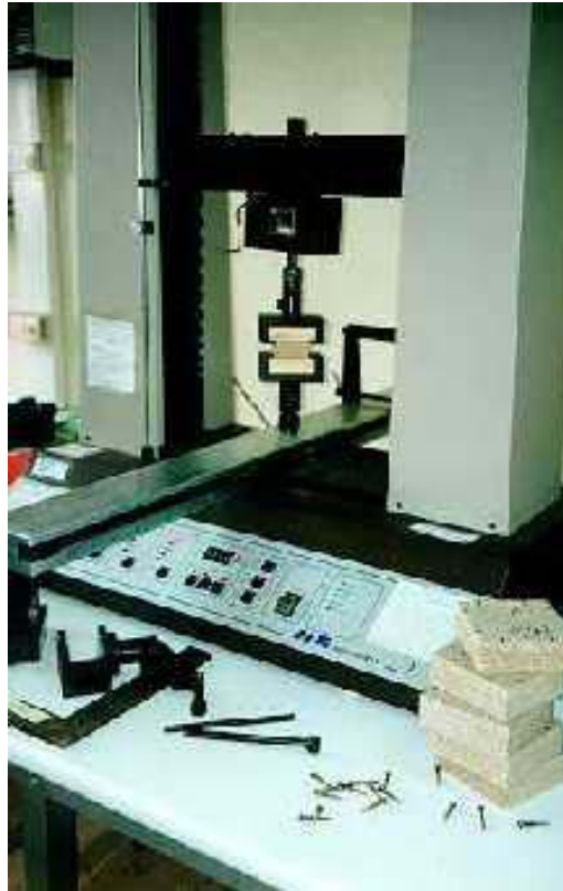
Máquina universal para ensayos de resistencia al esfuerzo cortante a tableros alistonados.
