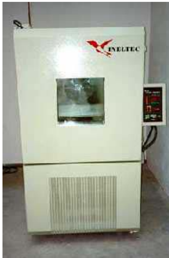
Cámara para el acondicionamiento de probetas y la realización de ciclos de envejecimiento
