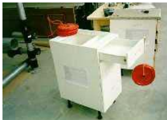
Resistencia de cajones a cargas concentradas en su extremo. UNE 56.841.93 Apdo. 7
