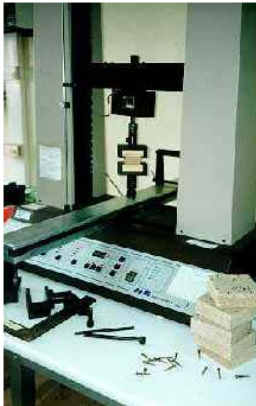
Máquina universal para ensayos de resistencia al esfuerzo cortante a tableros alistonados. UNE 56.777.92 Parte 1
