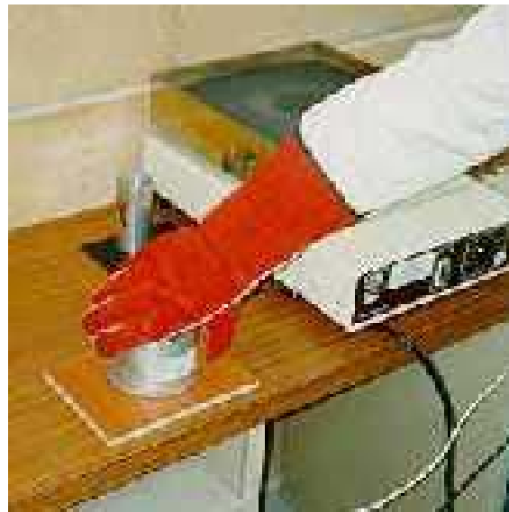
Situación del recipiente de duraluminio sobre la probeta para ensayos de calor seco/húmedo UNE 56.867.94 Apdo 6.1 y UNE 11.019.89 Apdo 2.3
